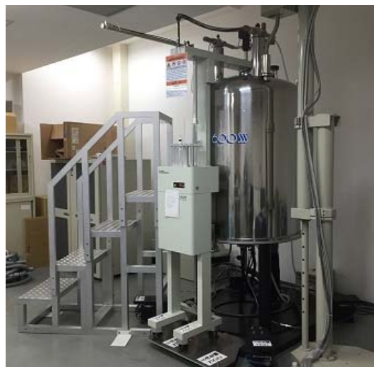
共用機器の一例 核磁気共鳴装置(NMR、ECA-600)
