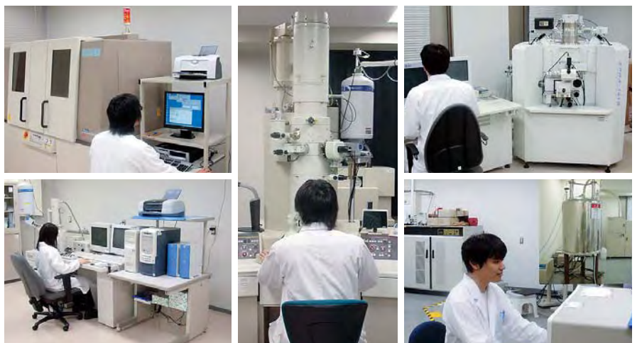
物質の化学構造や物性解析に威力を発揮する高性能大型分析装置（分析電子顕微鏡，FT-NMR，EPMA，X-線回折装置） High efficiency apparatuses of instrumental analysis for material research (TEM, FT-NMR, EPMA, SEM and X-ray diffractometer)
